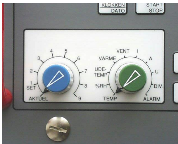
AKTUEL + TEMP Das Display zeigt die aktuelle Temperatur
